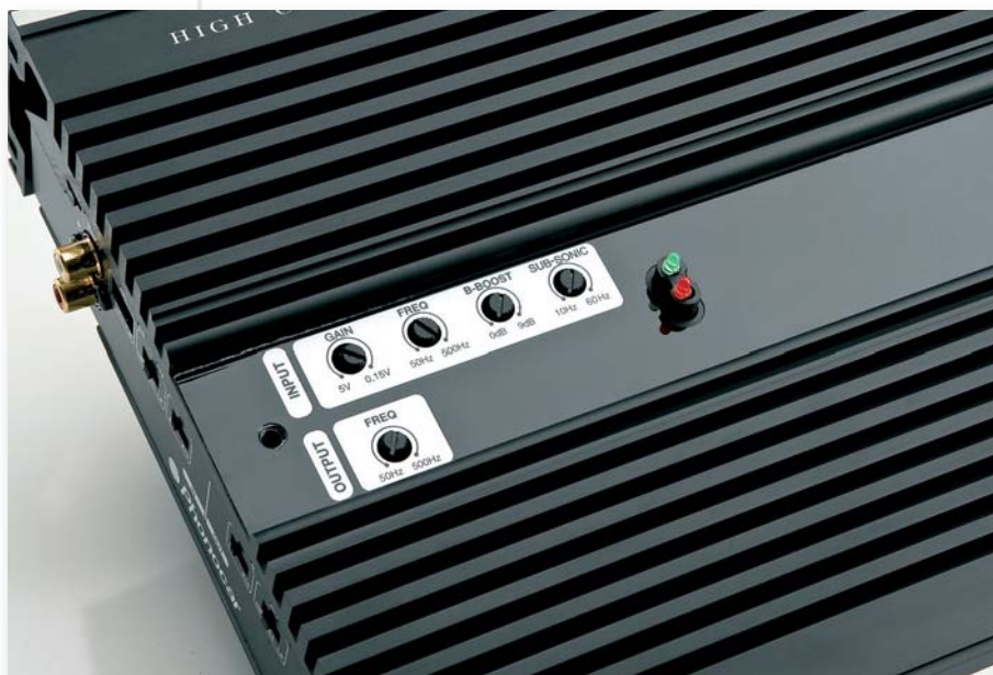
I controlli di I/O dell'X.O.T., a complemento dei deviatori vicini agli ingressi, sono posti sotto il pannellino superiore.
