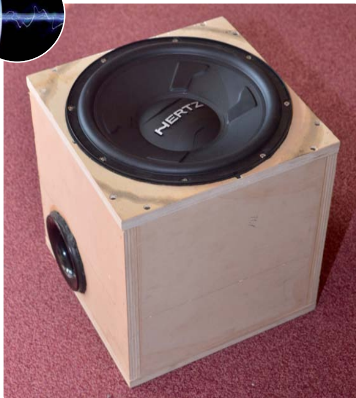
Il DS 30.3 rende molto bene nella cassa accordata da 24 litri, con condotto da dia. 80x175 mm, consigliata dal manuale.
